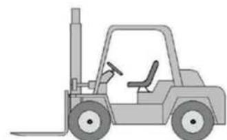
Si l'utilisation d'un chariot élévateur est nécessaire, enfourcher l'appareil en partie basse en utilisant la palette bois. Utiliser des fourches de chariot élévateur aussi longues que la largeur de l'appareil à manipuler.
