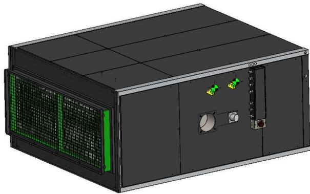
Sur les versions horizontales, le caisson filtre se monte à l'arrière, sur le dessus ou sur le dessous. Cette dernière configuration peut être rendu impossible suivant le système de supportage.
