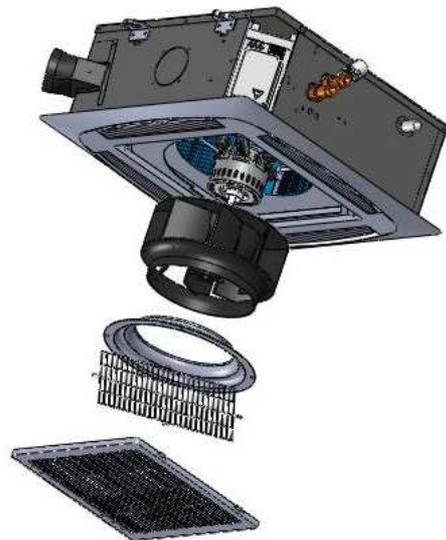
Retirer le moteur en dévissant les quatre boulons et débrancher le connecteur du câble du moteur du ventilateur.
