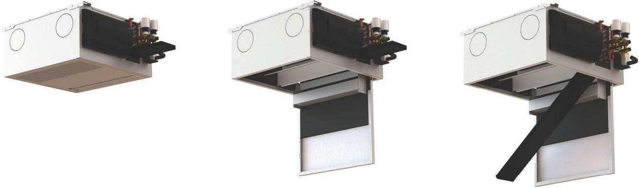
Spécialement adaptée pour les applications en milieu hospitalier et les installations en zone tropicale (outre-mer), la cassette Bora permet de faciliter les nettoyages, désinfections et donc de lutter contre le développement des légionelles. Par simple basculement de la dalle, on peut extraire le bac, le sécher, le désinfecter, le contrôler.
