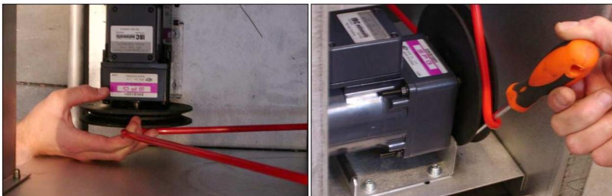
6. La courroie est maintenant montée. Vérifier si la tension est bonne. Si elle ne l'est pas, couper à nouveau un bout de courroie et reprenez la procédure à partir de l'étape 3.
