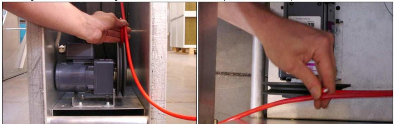
4. Couper la courroie à la bonne longueur et joindre les extrémités à l'aide de la pièce de jonction en utilisant une pince.
