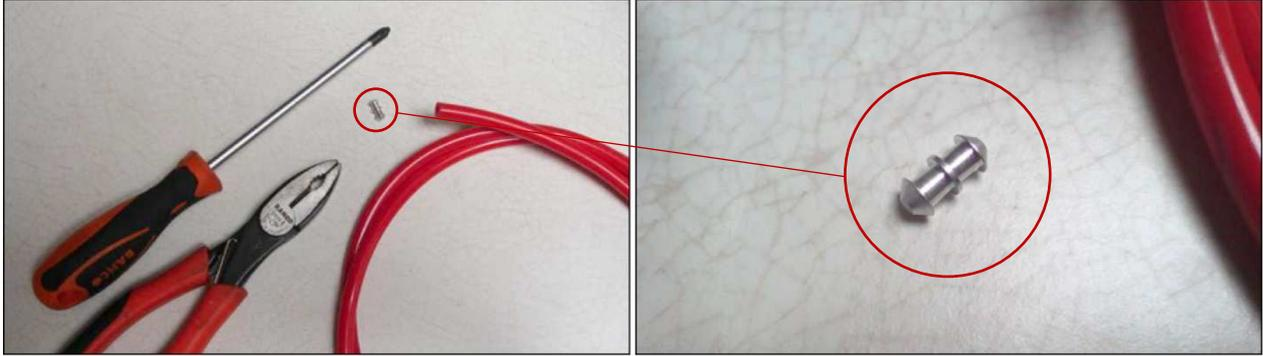
1. Mettre la pièce de jonction dans la courroie à l'aide d'une pince.
