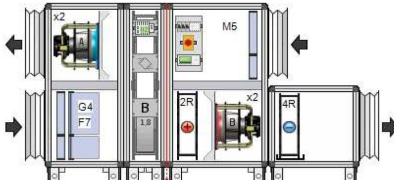
Configuration recommandée : avec caisson vide d'accès/maintenance (ou par une gaine intermédiaire à charge de l'installateur)
