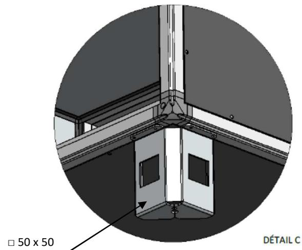
L'unité étant munie de pieds, l'installation devra se faire sur un sol parfaitement plat ou sur un longeron rigide et parfaitement droit afin que chaque pied soit correctement en appui sur le sol et/ou sur le plot amortisseur (voir chapitre installation).
