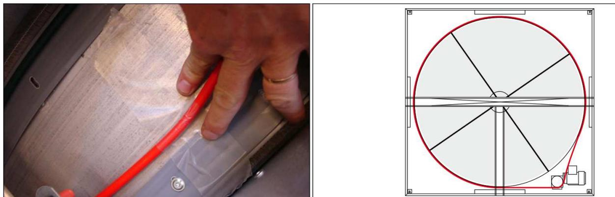
3. Mesurer la longueur de la courroie : la longueur de la courroie est bonne lorsque la tension est adéquate.
