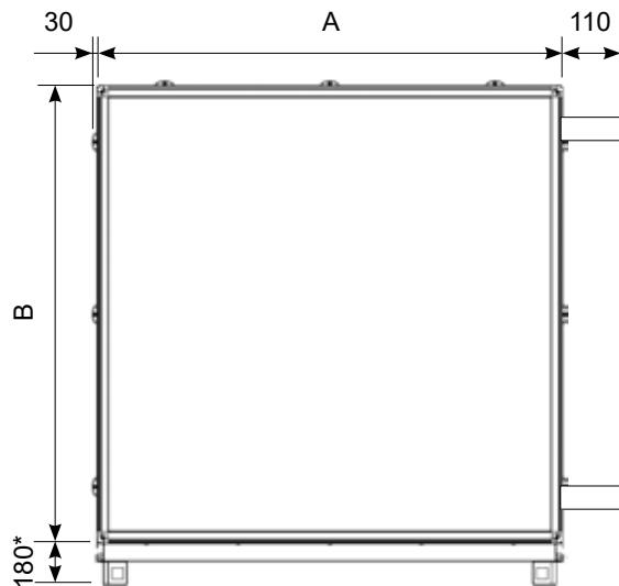
\* Pieds de 100mm fixés par vis au pas métrique sur un châssis périphérique de 80mm non démontable.
