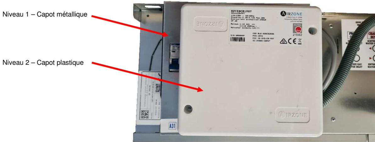
Pour accéder au niveau 1, dévisser la vis de fermeture du capot métallique puis le faire pivoter.
