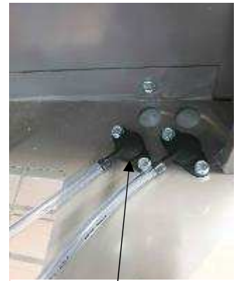
Fig. 1 Connecter le tube transparent le plus excentré sur le connecteur situé du côté où le filtre sera positionné.
