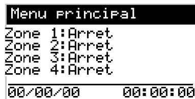
Depuis le menu principal il est possible de choisir les événements de chaque Zone (arrêt, réduit, confort, horloge ou inactif si la zone n'est pas utilisée).
